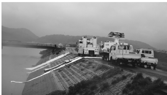
国土省倉吉河川国道事務所は、内水被害防止のため、国府川でポンプ車を稼働(9月3日(土)午後3時30分撮影)
