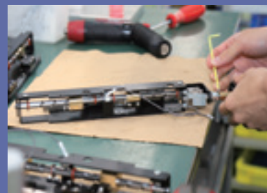
歯科用レントゲン装置完成までに、数えきれないほど多くの部品を、1つ1つ人の手で組み立てています。
