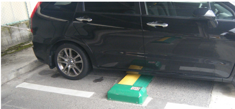
③ 駐車すると約3分後にフラップ板が自動で上昇します。
