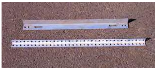
改修に使うL型鋼
