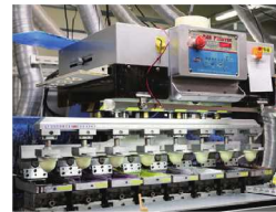
顔はタンポ印刷でプリントします。曲面に対して眉毛や目元のシャープな線が表現できるのがタンポ印刷の特徴。
