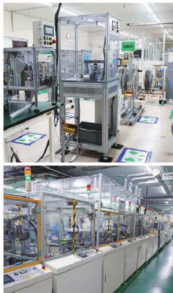
岡山事業所の組立製造現場も倉吉本社に移転。ガスメーター用のスイッチやセンサーを製造するクリーンルームです。
