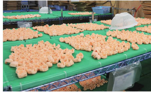
フィギュアの顔パーツ。よごれや傷がないか人の目で検査しあと洗浄し、細部の陰影や顔などをペイント・印刷します。
